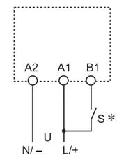
\*連有直流電源的情況下，正極性必須連接至B1終端 (根據EN 60204-1)。開關S應專門用於將控制訊號提供給終端B1。(此時不得連接其他任何負載)。
