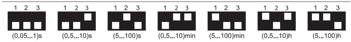
注意：時間刻度和功能必須在對計時器通電前設定。若要達到0.05秒最小時間設置，必須使用利用控制訊號的功能之一。設定極短時間時，可能需要考慮所用繼電器的操作時間。
